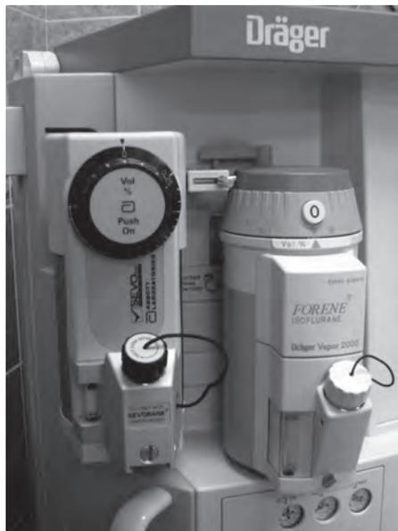
**Рис. 7.3.** Испарители высокого сопротивления. Слева – испаритель Datum для севофлурана (Blease, Великобритания); справа – испаритель Varor 2000 для изофлурана (Dräger, Германия).
